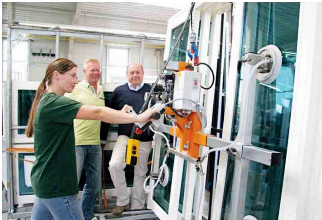
**Eine Schiffsbalkontür wird reisefertig gemacht:** Metallbaumeisterin Tatjana Gritzke arretiert die Konstruktionen in der Produktionshalle in Lieme auf einer Spezialpalette, die anschließend in Container verpackt wird und zur Meyer-Werft nach Papenburg geht. Mit im Bild (von links): BSS-Geschäftsführer Thomas Scharf und Prokurist Wolfgang Vosselmann.
